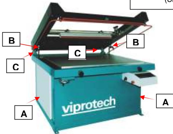
Cette photo indique la position des différents points de graissage. A effectuer au moins une fois par an (à adapter selon la fréquence d'utilisation du matériel).
