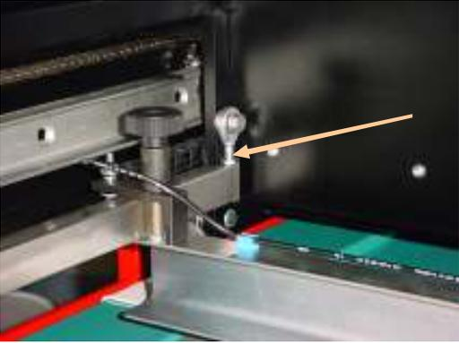
Vérifier le serrage du contre-écrou des rotules.
